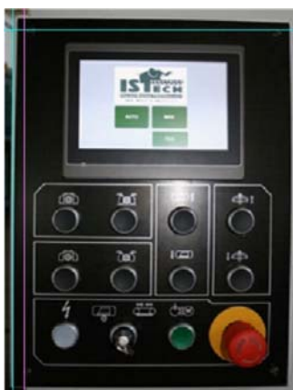
Panel der ISTech Power NC Sägeautomaten Pupitre d'opérateur pour les automatés ISTech Power NC
