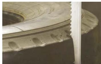
**SISO-HM-TYRE** Hartmetall bestücktes Spezial- Scie à ruban à plaquettes métal Special carbide tipped band Sägeband für das Trennen von Reifen. Scie à ruban à plaquettes métal pour le tronçonnage des pneus. Suitable: for any kind of Reifen. Geeignet für sämtliches Reifematerial. Pour: Conçue pour divers de pneu
